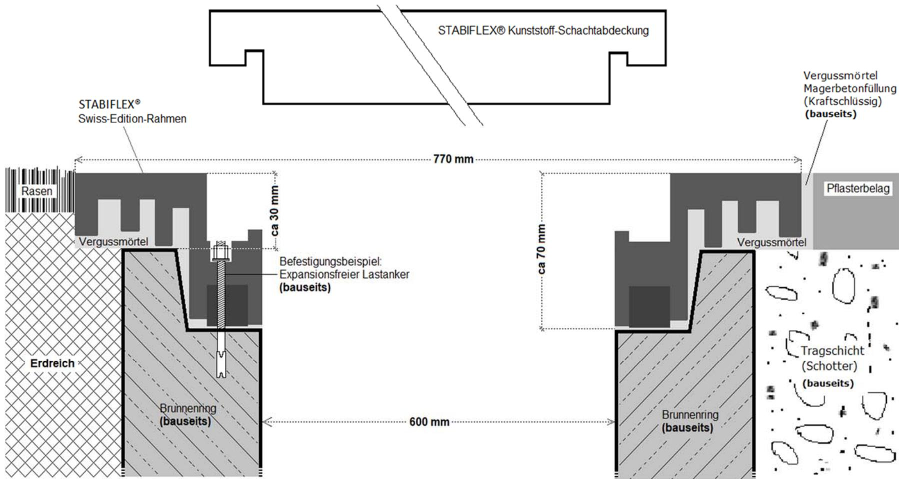
**\*Empfehlung für direkte Montage auf Normalbetonrohr, Brunnenring oder Betonkonus.**
