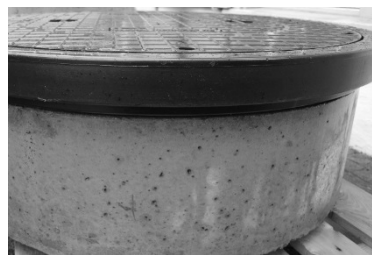
Foto 5 STABIFLEX BASIC XXL Blockrahmen, Ø aussen 1040 mm. Montiert auf DN 800 Normalbetonrohr-/Brunnenring. ist die Aufbauhöhe ca. 85 mm
