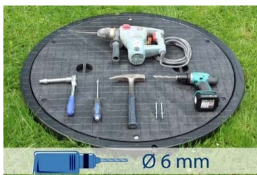
Foto 11 STABIFLEX BASIC XXL mit Blockrahmen. Einfache und schnelle Montage, wenige Werkzeuge. Befestigung mit 2 expansionsfreien Lastankern (Bolzenanker) M6 x 97 mm. Befestigungssets L ist nicht im Lieferumfang enthalten, separat als Zubehör erhältlich.
