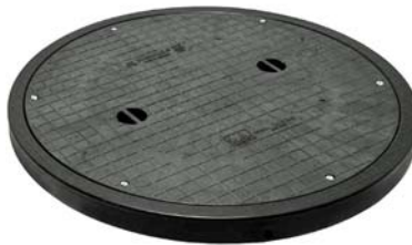
Foto 2 STABIFLEX BASIC XXL mit Universal-Blockrahmen und Deckel mit 6-facher Verschraubung, EPDM-Dichtung. Tagwasserdichte und geruchshemmende Ausführung
